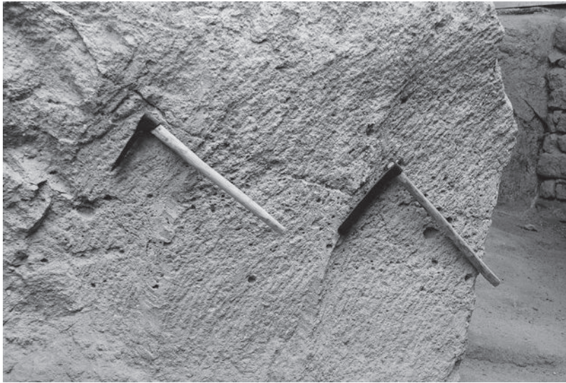
AFBEELDING 2A: De typische werktuigen die in de Romeinse winning te Kretz werden gebruikt (Jacquo Silvertant)
