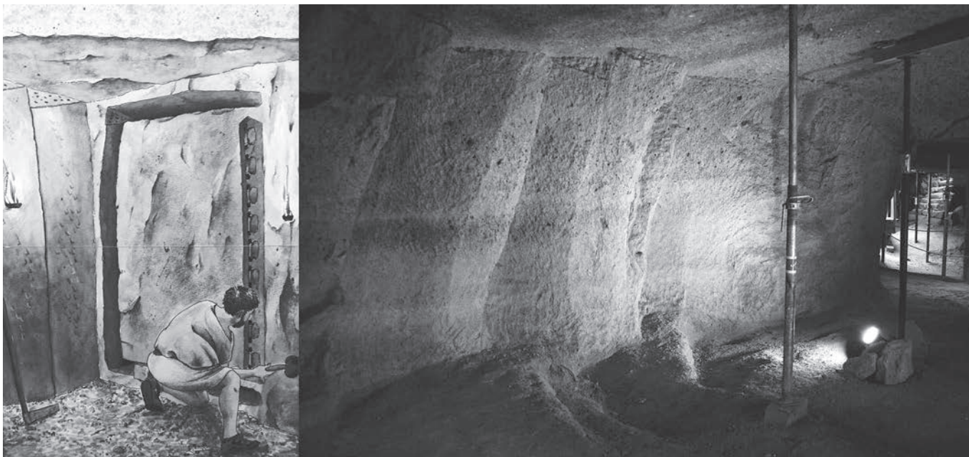
AFBEELDING 2B: Een ondergronds werkfront in de groeve Meurin. Links een impressie van hoe de Romeinse blokkreker hier te werk ging (Jacquo Silvertant)
